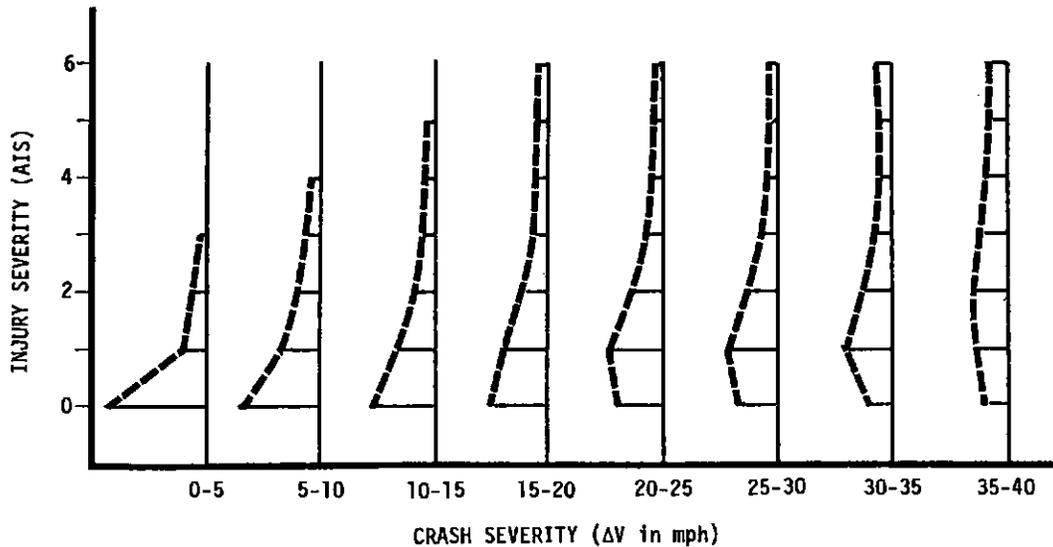
FIGURE 12-1. ILLUSTRATION OF THE COMPUTATION OF INJURY SEVERITY DISTRIBUTION FOR RESTRAINED OCCUPANTS
