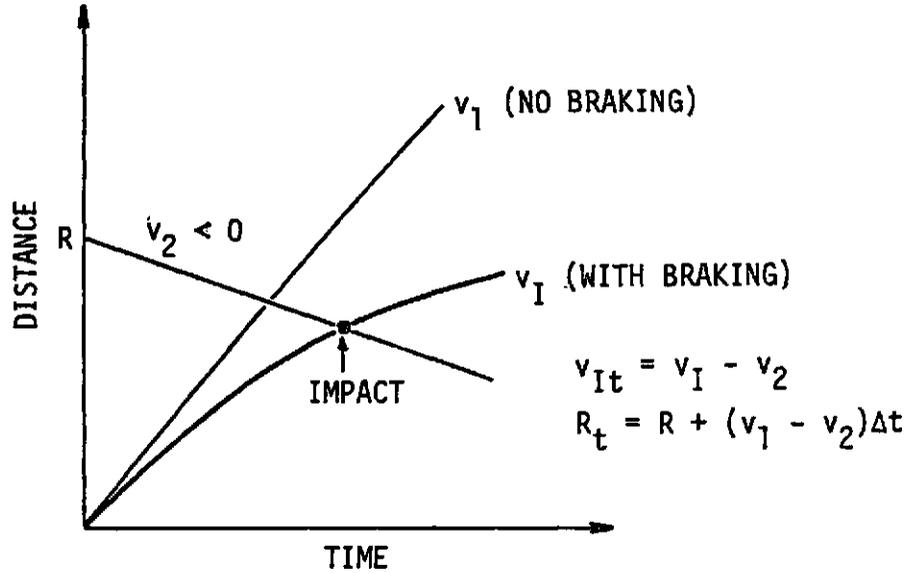
FIGURE 9-8. DISTANCE/TIME RELATION BETWEEN TWO VEHICLES, ONE OF WHICH IS BEING BRAKED
