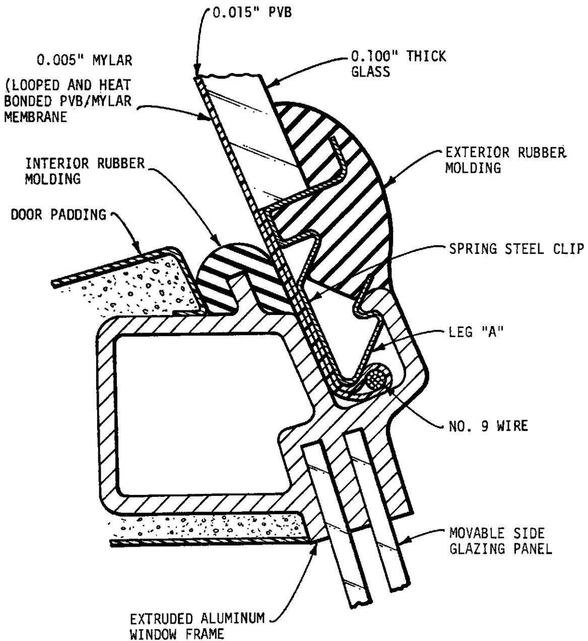
FIGURE 4-6. PHASE II SIDE GLAZING -- CROSS-SECTION OF LOWER ATTACHMENT AREA
