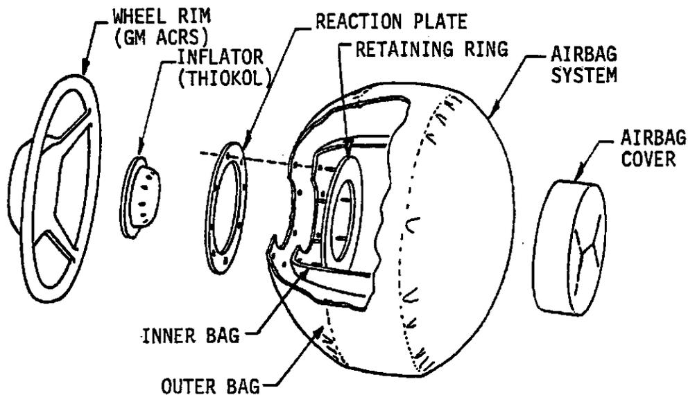
FIGURE 4-1. PHASE II DRIVER AIRBAG MODULE
