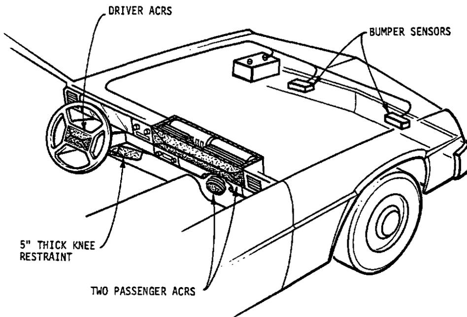
FIGURE 11-18. MAJOR COMPONENTS OF THE RESTRAINT SYSTEMS
