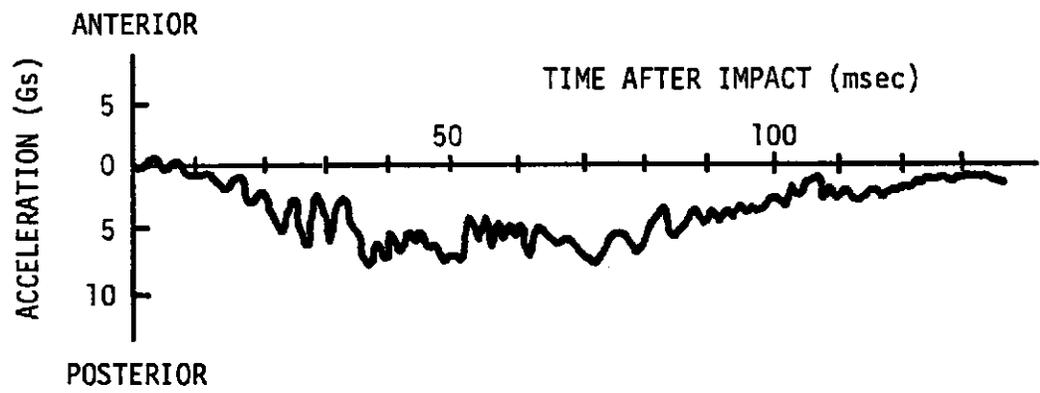
FIGURE 3-11. RSV FRONT COMPARTMENT LONGITUDINAL ACCELERATION DURING 8.0 MPH FRONTAL BARRIER IMPACT
