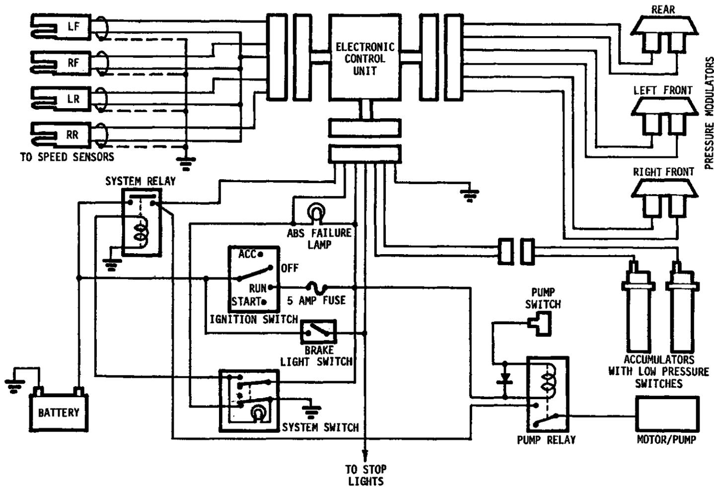
FIGURE 5-5. ELECTRICAL SCHEMATIC OF THE BENDIX ANTI-SKID BRAKE SYSTEM
