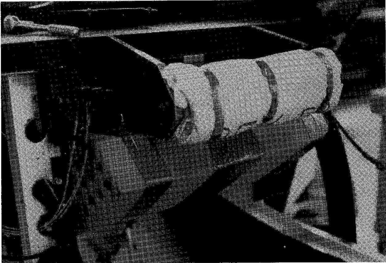
FIGURE 4-18. PASSENGER RESTRAINT SYSTEM
