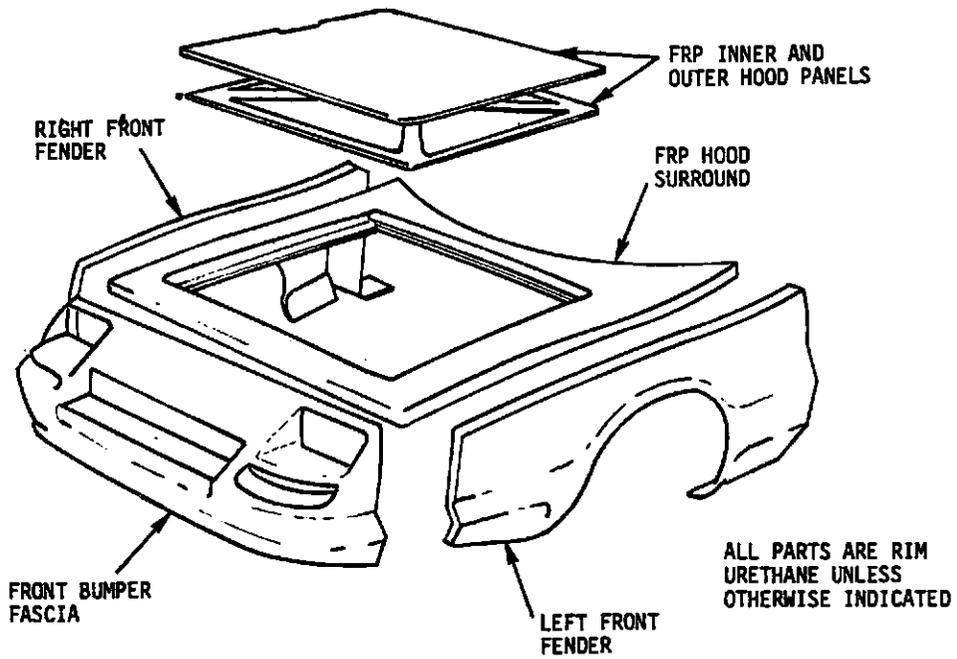
FIGURE 7-1. FRONT EXTERIOR PARTS
