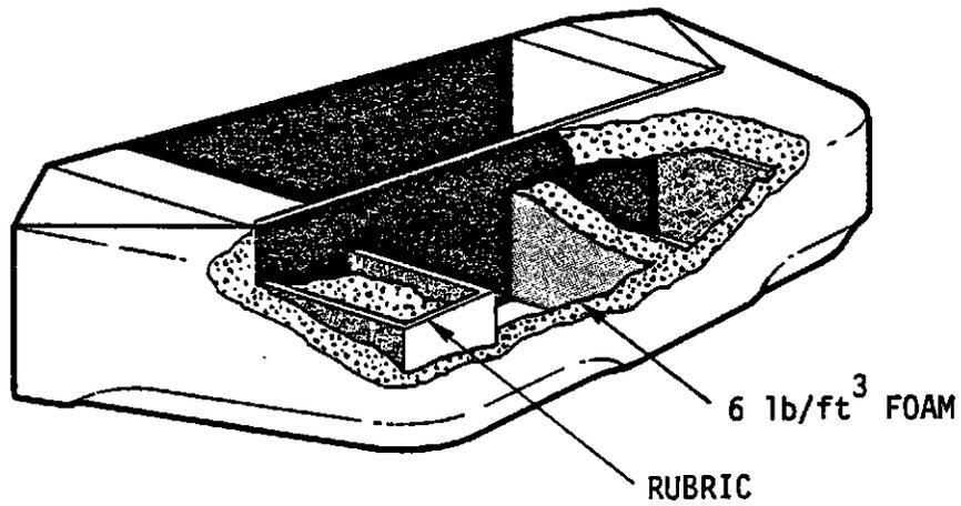
FIGURE 3-10. RSV FRONT BUMPER CONFIGURATION
