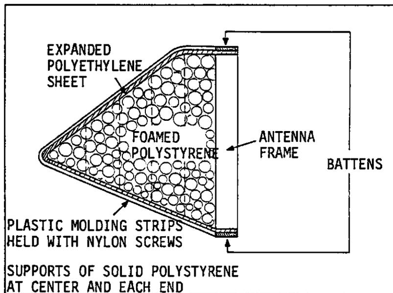
FIGURE 9-6. RADOME CONSTRUCTION
