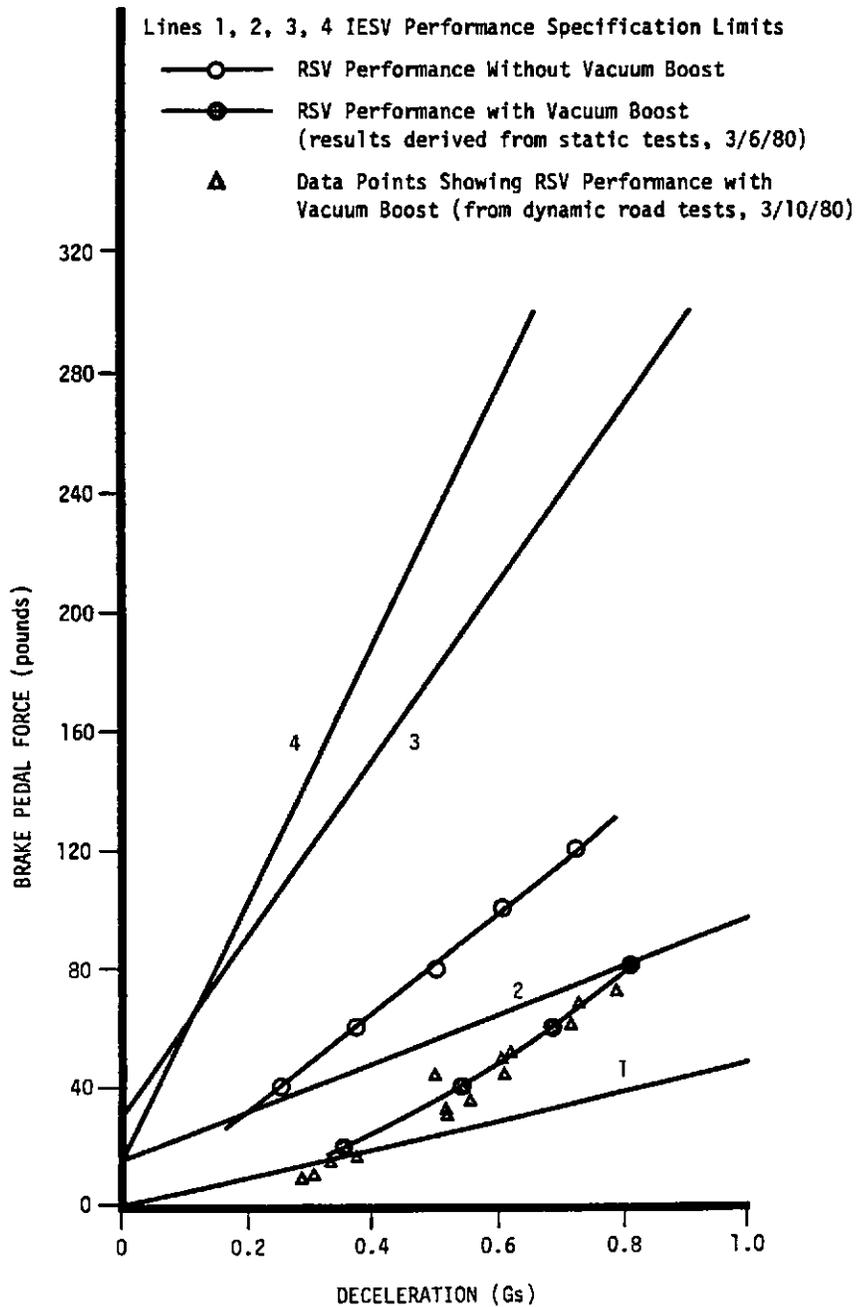
FIGURE 10-1. VEHICLE DECELERATION VERSUS BRAKE PEDAL FORCE
