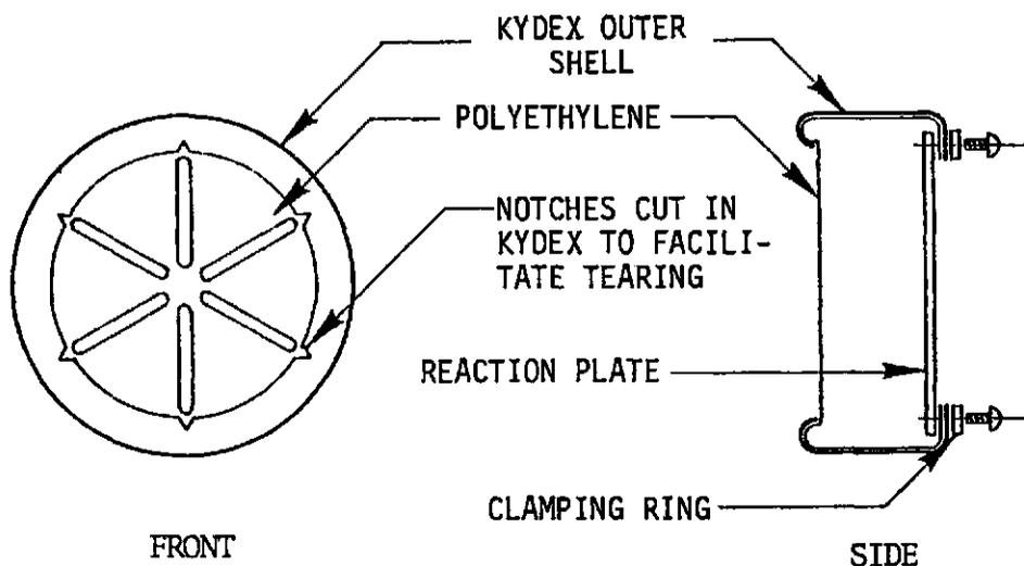
FIGURE 4-8. AIRBAG COVER CONFIGURATION
