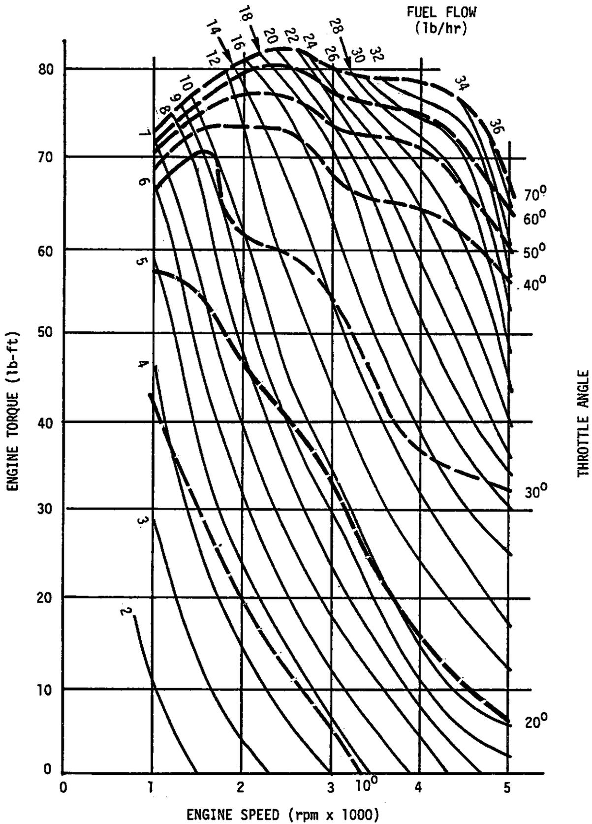
FIGURE 6-1. ENGINE FUEL CONSUMPTION MAP
